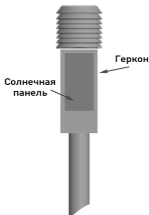
Рисунок 2 - активация комплекса с помощью магнитного ключа (магнита).
